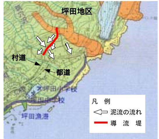
図-1 泥流の流れと導流堤建設箇所
