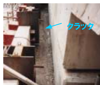
図8 試験終了後の背面盛土の状況（A3橋台）
