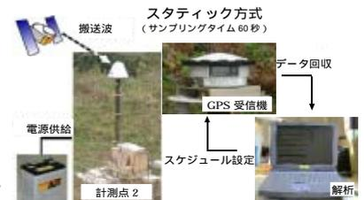
図-2 計測システムの概要
