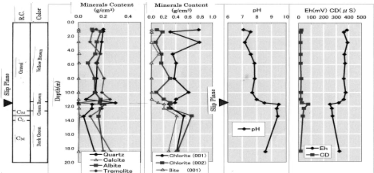
図-1 鉱物組成と pH、Eh 及び CD の鉛直変化
