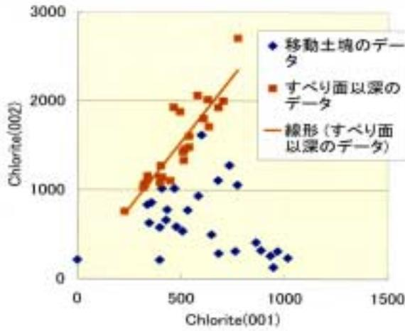
図-2 移動土塊と不動土塊でのクロライトの X 線データの相違
