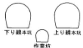
図2 関門トンネル横断面図
