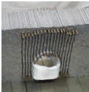
写真-1 地山および縫地ボルトモデル
