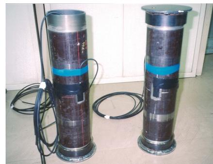
写真 - 2 モルタルを充填したテストピース
