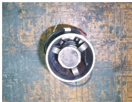
写真 - 1 A G F 鋼管とパイプひずみ計の切断面
