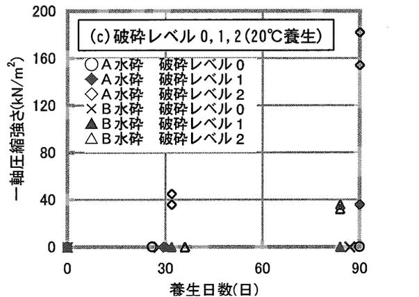
図-2 一軸圧縮強さの経時変化
