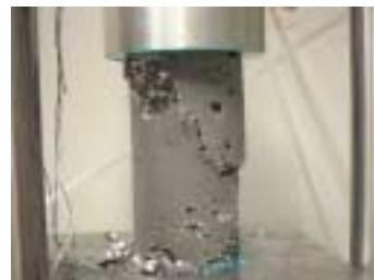
図4. 一軸圧縮試験破壊状況
