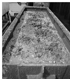
写真-2.シールド排泥
