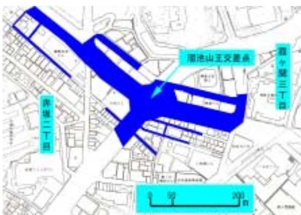
図1 交差点浸水位75cmにおける浸水域
