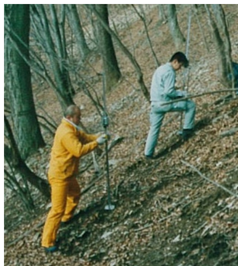
写真 1 現地土層厚調査状況
