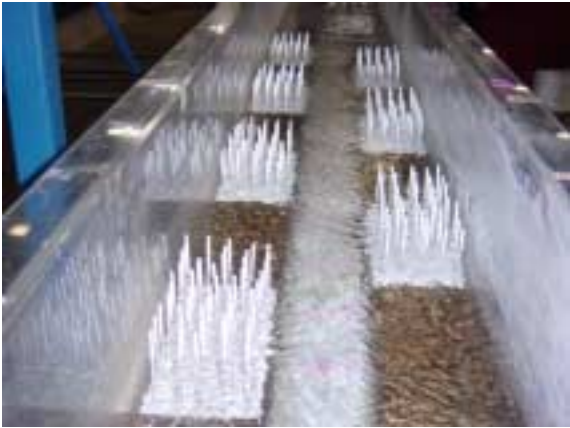
写真-1：実験水路写真
