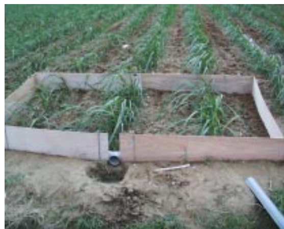
写真-1 土砂流出量の測定装置（畑1）
