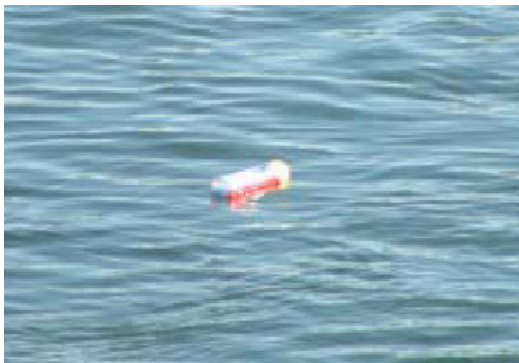
写真-3 観測用フロートの流下状況
