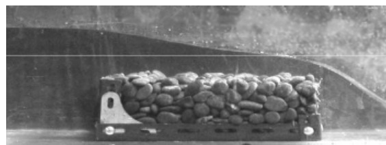
写真-2 越流型流れの様子
