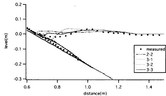
図5 界面抵抗継続時間  $t_{inter}$  の影響
