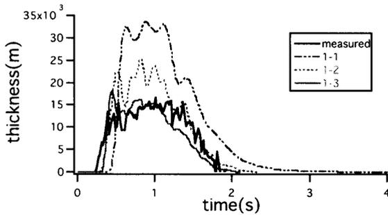
図2 底面粗度係数  $n$  と水平拡散係数  $\nu$  の影響 (変位計③ $37^\circ$ )
