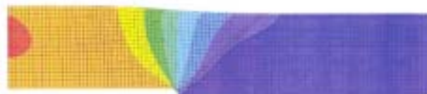
図6 断層角度 45° の表層地盤変位分布図
