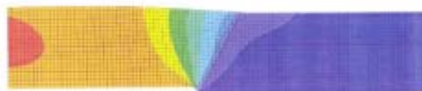
図7 断層角度 63.3° の表層地盤変位分布図
