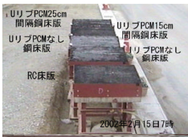
写真-1 結露凍結時の模型橋
