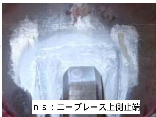
図3 静的載荷試験結果の一例 (n s)
