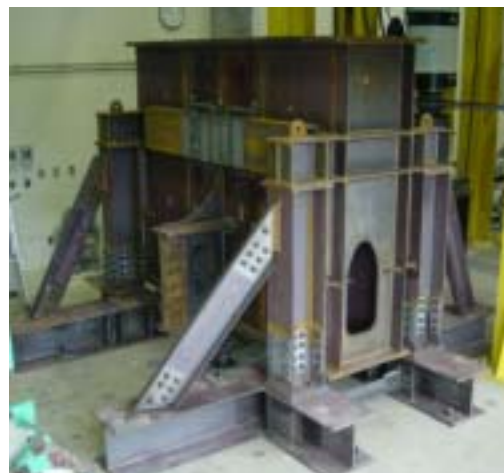
写真1 実物大疲労試験供試体
