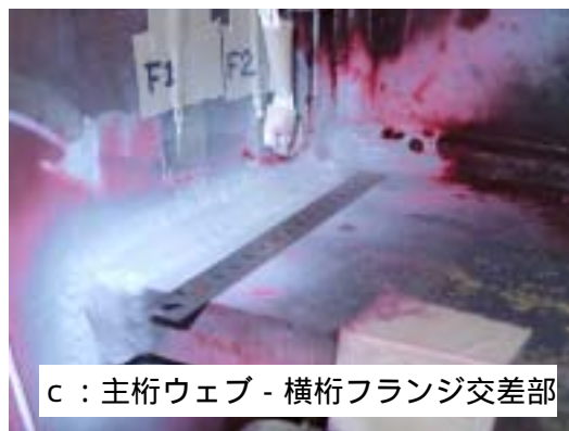
図4 疲労試験後のPT結果例
