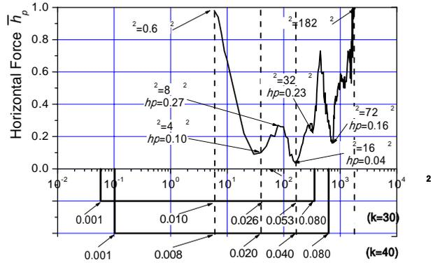
図-5 圧縮力が出現する支点変位による変動軸力
