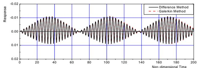
図-2 中央点の変位の時刻歴応答
