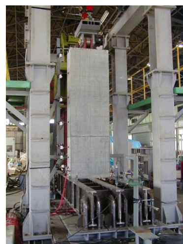
図－3 単調載荷実験の状況
