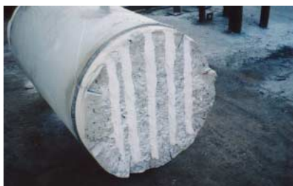
写真2 供試体切断面
