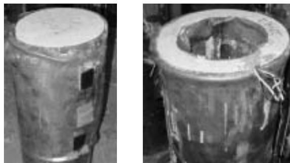
(a) S 破壊 (b) B 破壊
