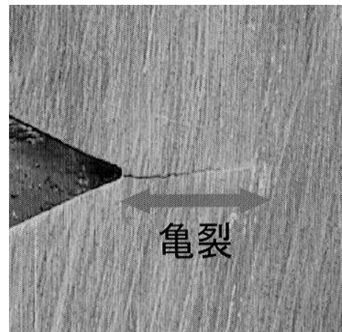
写真2 亀裂の観測例
