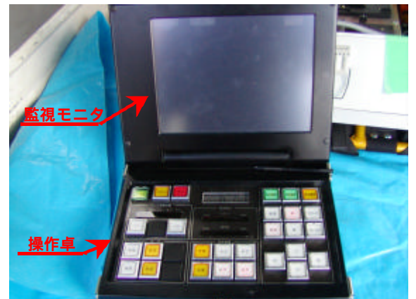
写真4 移動基地局の操作ユニット
