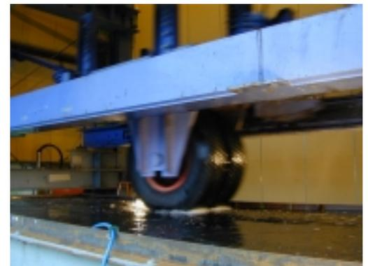
写真-1 水浸輪荷重載荷試験状況
