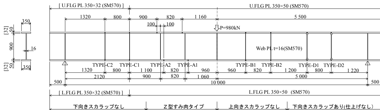
図2 鋼桁現場溶接模型疲労試験体
