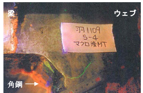
写真-3 F-F タイプの事例（き裂 C）
