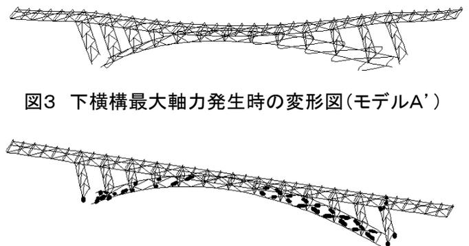
図3 下横構最大軸力発生時の変形図(モデルA')
