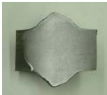
写真 1 ガス圧接溶接継手部
