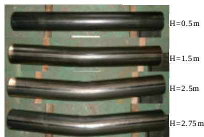
写真-1 CFT 鋼管の損傷モード
