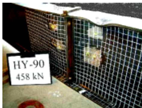
Photo.1 座屈後供試体
