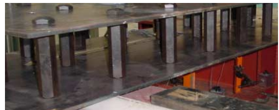
写真 - 1 サンドイッチ床版の構造
