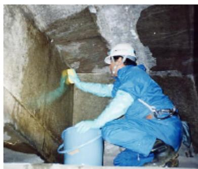
写真-1 濁水の採取方法
