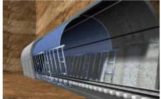
図1 薄肉トンネル補強工イメージ
