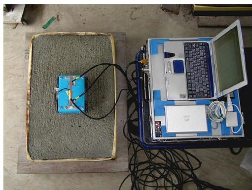
写真-2 RC 板供試体とレーダ計測システム
