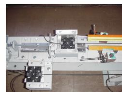
写真-1 固定治具（可動端）
