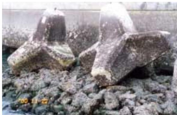
図1 海水暴露10ヶ月後の状況(暴露条件:干満帯)
