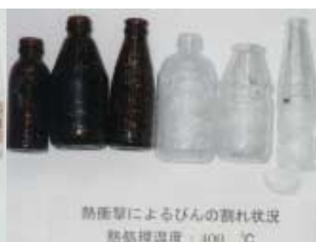
写真-2. b 熱処理温度400
