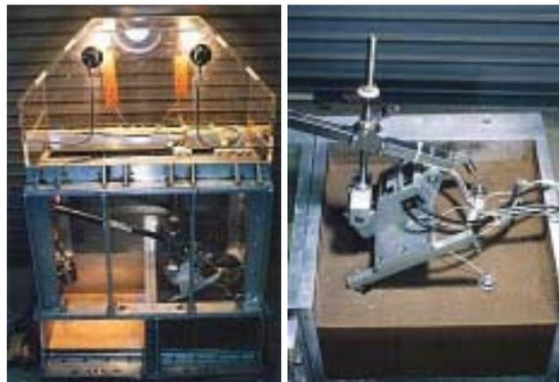
写真1 実験容器に装填した模型クレーン(左)及びアウトリガーが地盤にめり込んで転倒した模型の様子(右)
