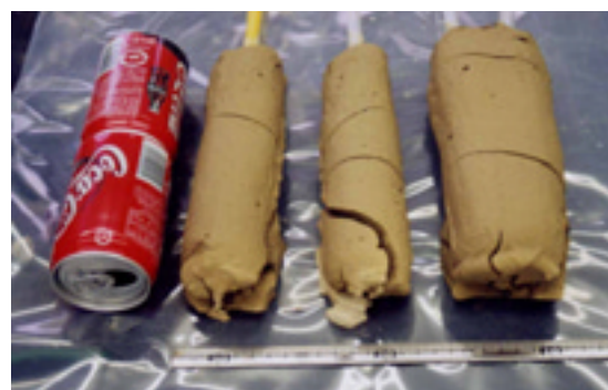
図-7 真空工法によって形成された土柱
