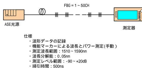
図 - 5 透過光観察による計測システムの構成
