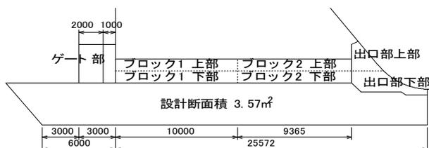
図 - 1 原設計工法による概略施工手順
