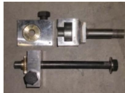
図-3 WW継手試験供試体(写真)
