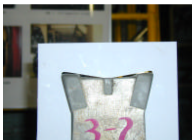
写真-7 交換ビットの摩耗状況 （バルブプレート型）
