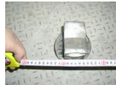
写真-6 交換ビットの破損状況 （ボールバルブ型）
