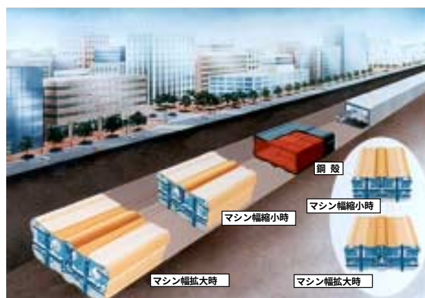
図-1 シールド機拡幅時の概念図
