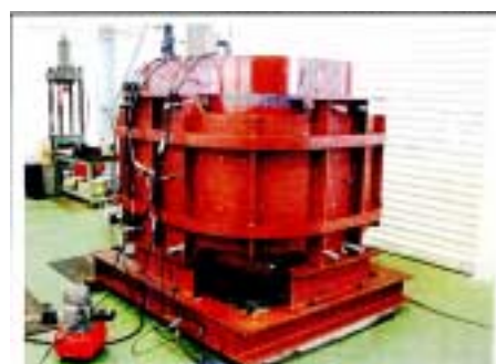
写真-1 本体シール止水実験装置
