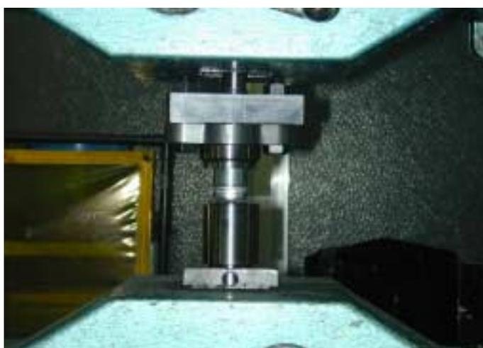
図4 リング継手引張試験状況
