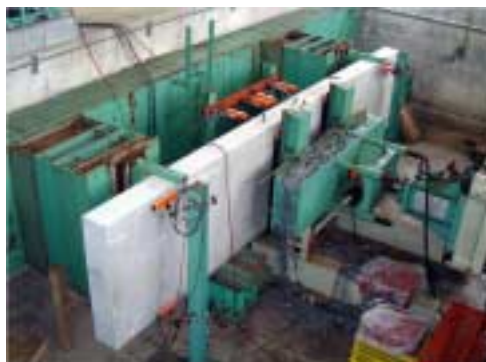
写真 - 2 継手曲げ試験状況
