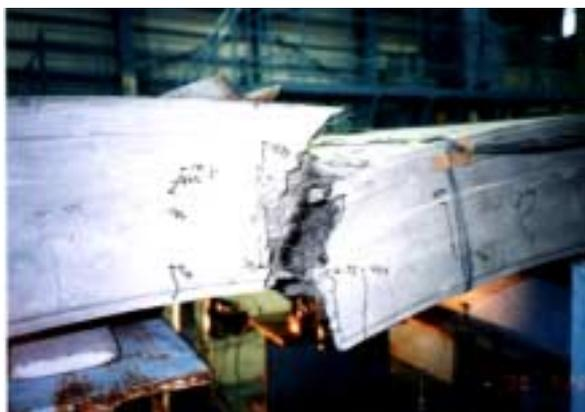
図5 供試体破壊状況( $V_f=1.0\%$ )
