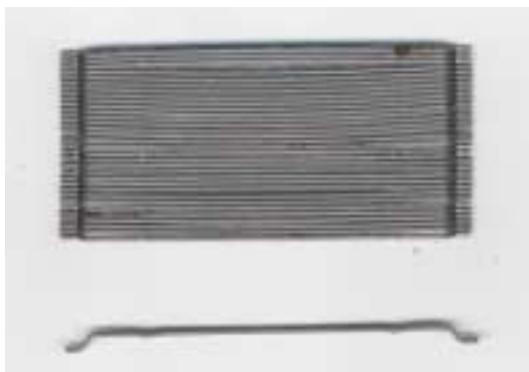
図 1 鋼繊維(両端フック型:  $L_f=60\text{mm}$ )
